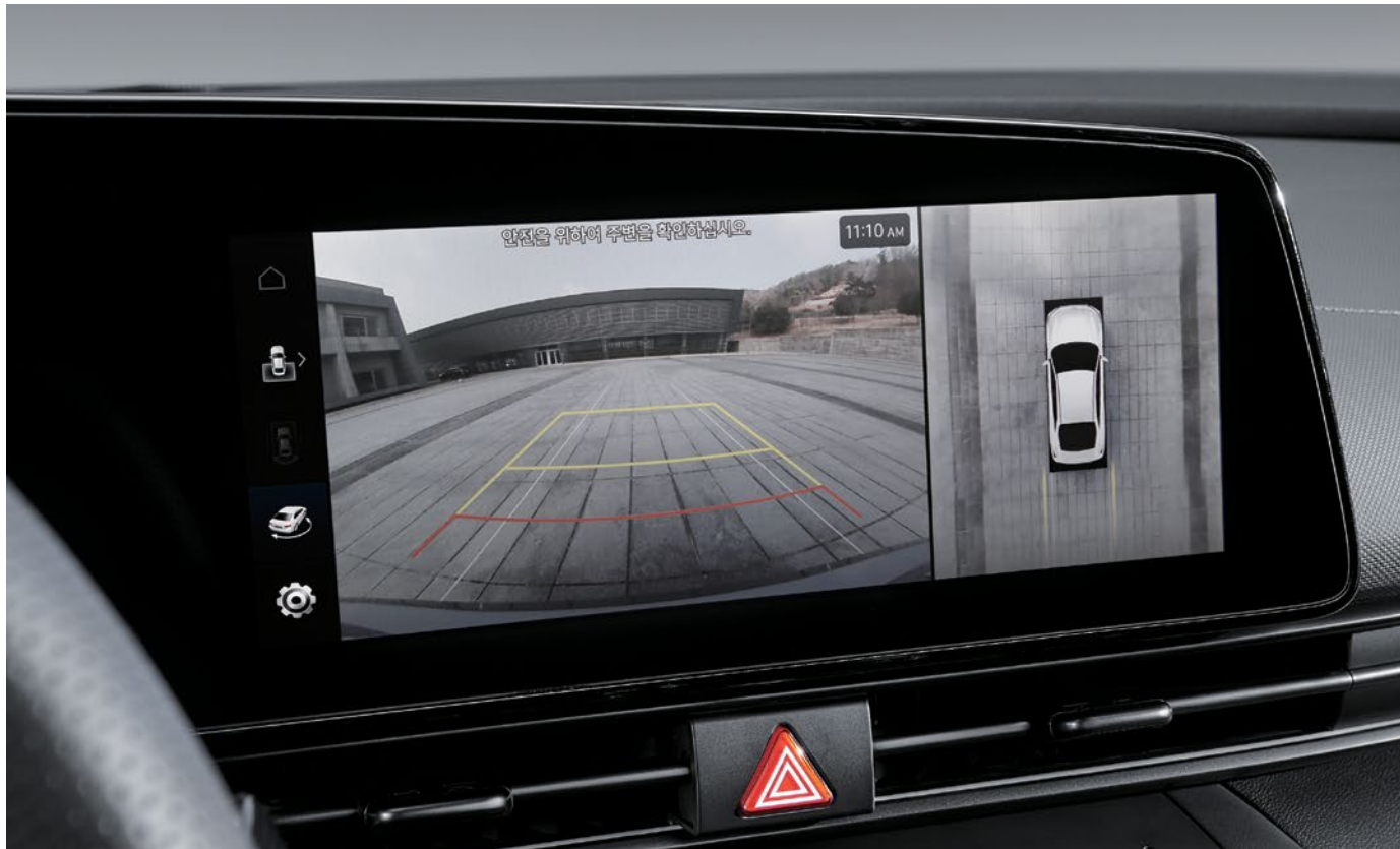
서라운드 뷰 모니터 안전한 주차를 위해 차량 주변의 상황을 고화질 카메라 및 디지털 영상 전송 방식을 적용하여 선명한 화질의 영상으로 보여줍니다.
