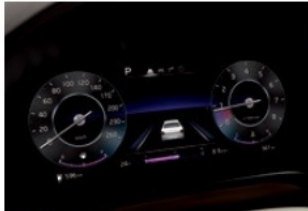
슈퍼비전 클러스터 (12.3인치 풀사이즈 칼라 TFT LCD)
