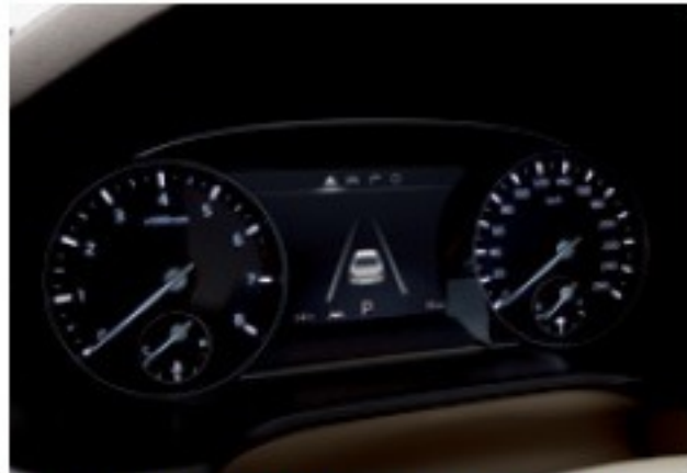
슈퍼비전 클러스터 (7인치 칼라 TFT LCD)
